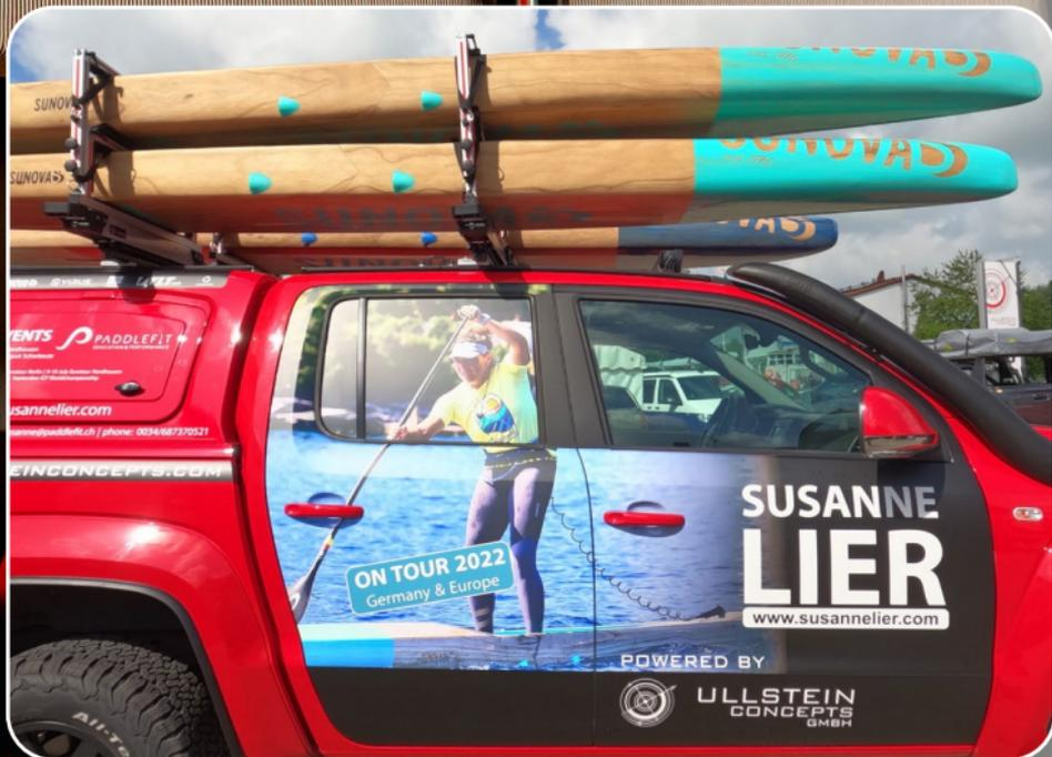
Gasdruckfedern reduzieren das Gewicht des Boards beim Anheben und Absenken um bis zu 18 kg. Wird der Träger nicht benötigt, ist er durch nur 1 Sicherungsbolzen zu entfernen und nur die Montageplatte bleibt am Fahrzeug auf dem Querträger.
