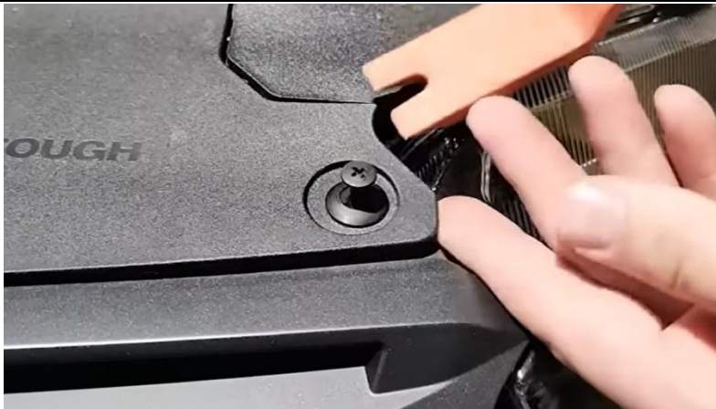
Abdeckung des Schloßträger demontieren
