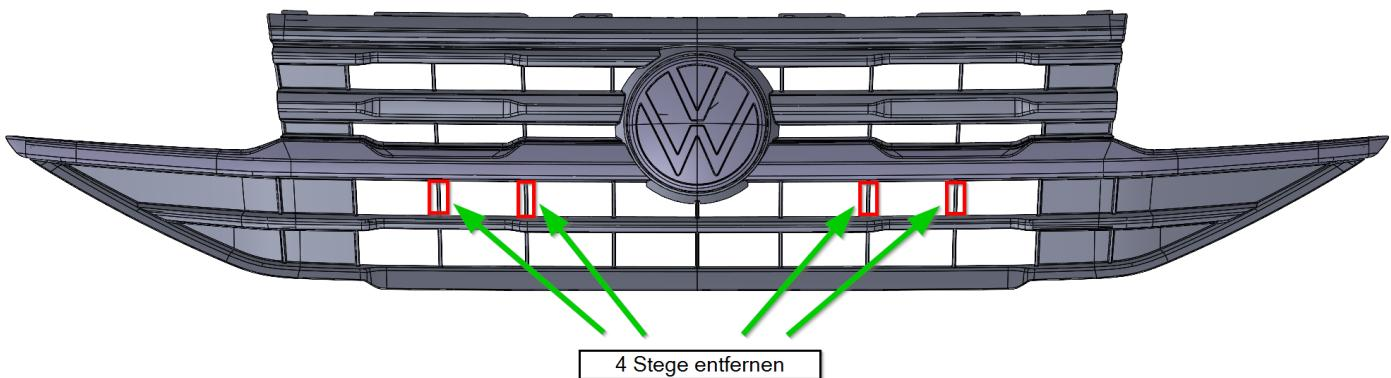
Die gekennzeichneten Stege entfernen.
