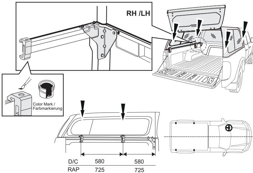
zur Montage der Frontwinkel ist zuvor zeitweilig eine Klammer im vorderen Bereich zu befestigen. Diese wird dann im nächsten Schritt weiter hinten befestigt.
