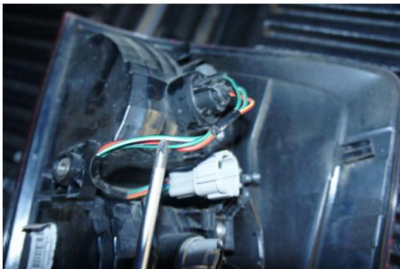
Anschluss Bremslicht im linken Rücklicht des Fahrzeug (connection to 3.Brakelight in left rear light):
