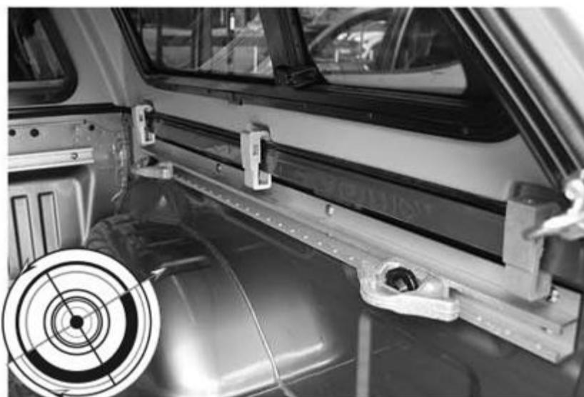
**Die Bilder zeigen die korrekte Befestigung der Hardtopklammern**
