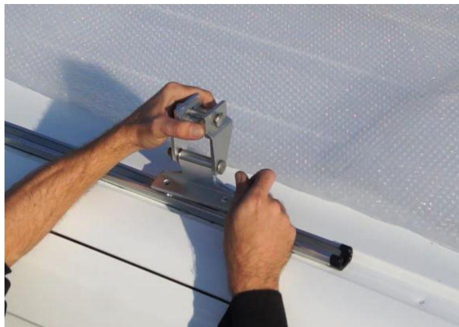
D - Dachträger auf das Fahrzeug setzen und befestigen:
