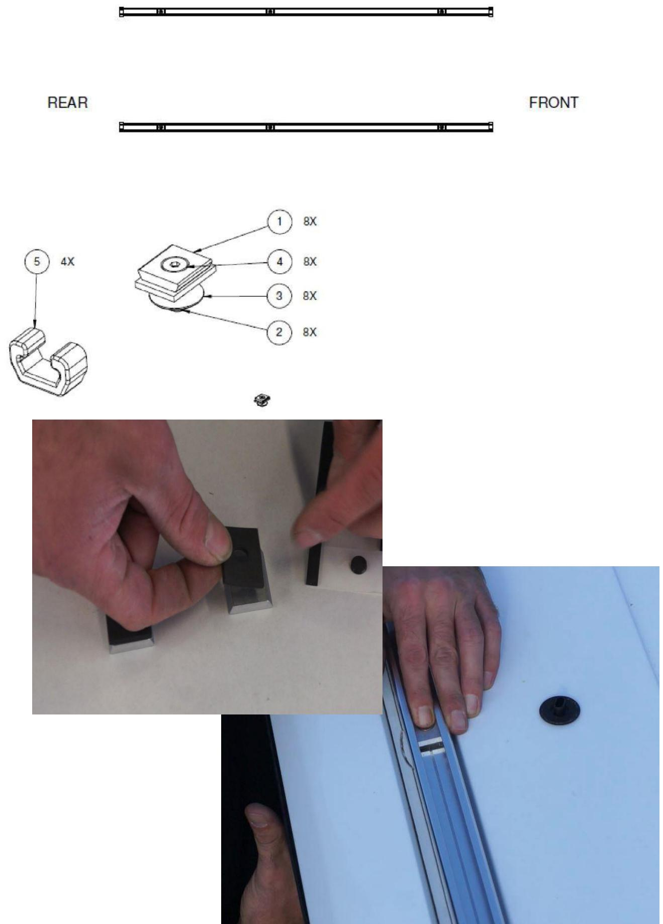
C – Haltefüße an den Dachschienen befestigen:
