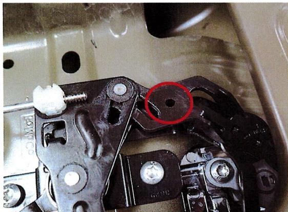
4) Bohren Sie unter Verwendung der Schablone die beiden Löcher, um den Stellmotor zu befestigen.
