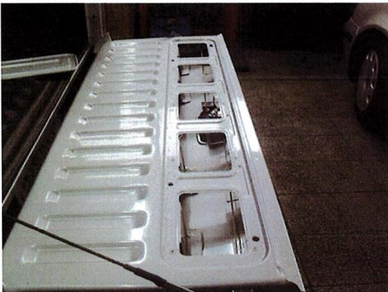
2) Bohren Sie ein 4mm Ø in den Schließmechanismus (wie abgebildet).
