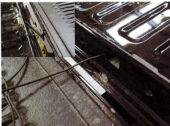
10) Führen Sie den Kabelbaum nun an der Fahrzeugunterseite bis in Höhe des Fahrersitzes, wo er durch eine vorhandene Öffnung in den Fahrgastraum geführt werden kann.\*\*
