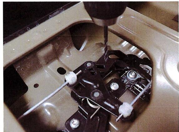
3) 4mm Bohrung in Schließmechanismus
