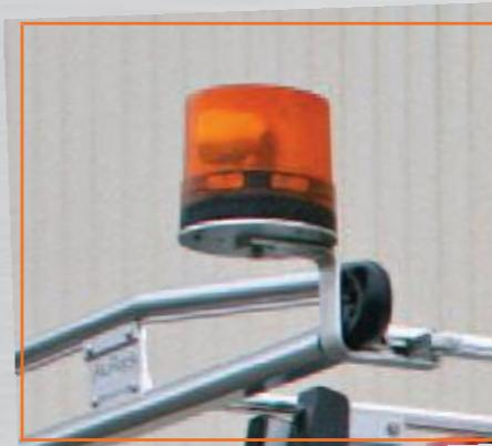
Die Montage von Rundumleuchten erfolgt auf speziellen Halterungen am Querträger.
