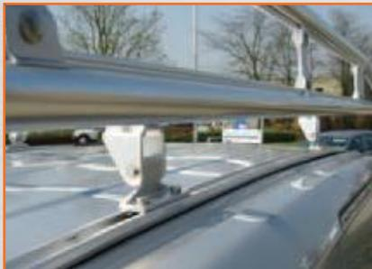
Die flexiblen Adapterschienen werden an vorhandenen Befestigungspunkten montiert und können zusätzliche Kräfte im Falle eines Unfalls aufnehmen.
