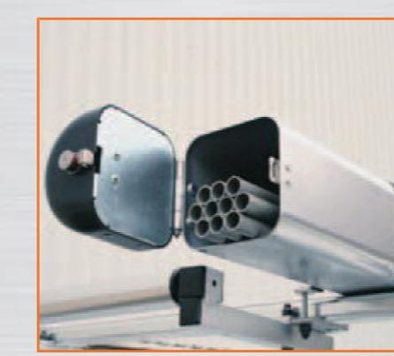
Beidseitig abschließbares Aluminium Laderohr (2-5 m lang, 125 mm im Quadrat). Die Montage erfolgt mit einem Bügel auf dem Querträger, so dass der Innenraum komplett zur Verfügung steht.
