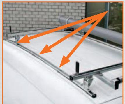
Adapterschienen, perfekt angepasst an die Fahrzeugkontur, werden an vorhandenen Befestigungspunkten montiert.
