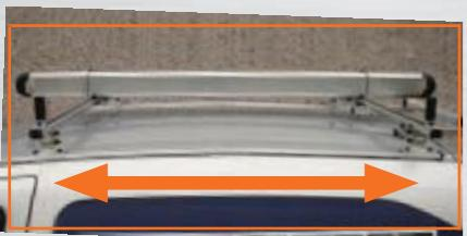
Das einstellbare Adapterschienen System dient zur optimalen Positionierung des Dachträgers.
