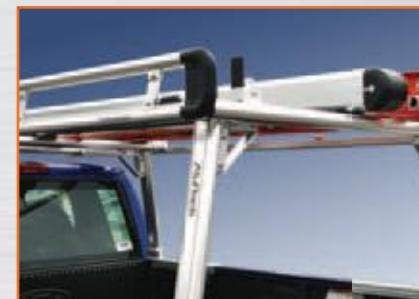
Optionale Seitenreling, Heckrolle und Zusatz-Querträger für einfaches Be/Entladen.
