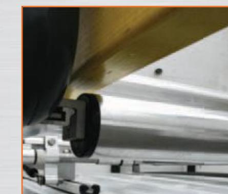
Die leicht zu montierende Laderolle am Heck des Dachträgers sorgt für ein bequemes Be- und Entladen von Langgut.
