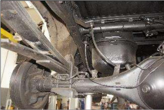
Stützen sie die Achse auf der entsprechenden Seite ab, bevor Sie mit den Demontearbeiten der Blattfeder beginnen.
