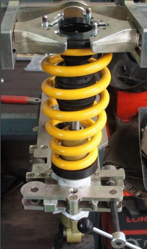
Zusammenbau des neuen Federbein mittels Federspanner
