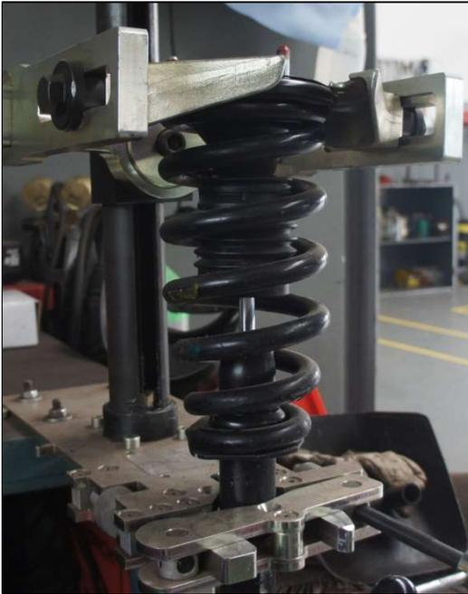
Zerlegung des werksmäßigen Federbein mittels Federspanner
