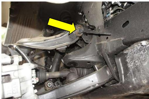
Hintere Aufnahme des Querlenkers mittels Kabelbinder oder Ähnlichem locker fixieren um diesen vor vollständigem Abkippen zu sichern.
