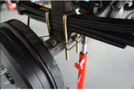
Befestigen Sie die Blattfeder an der Achse mittels der U-Bügel
