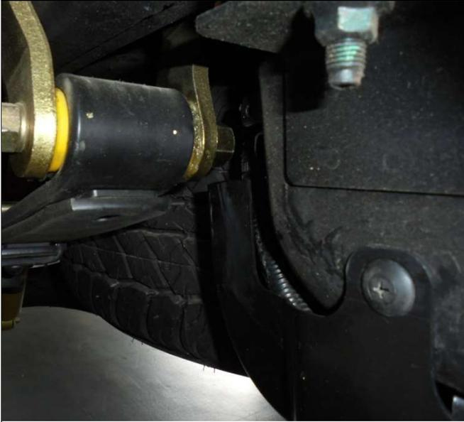
Demontieren Sie die Plastikabdeckung am Ad Blue Tank neben dem Federschäkel hinten links.
