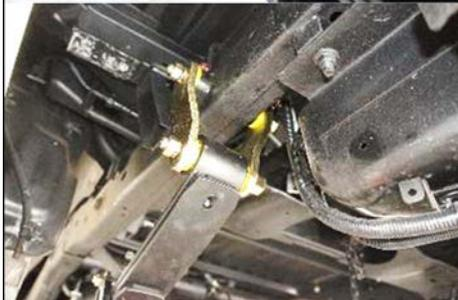
Entfernen der Schakel, und der Gummilager der vorderen und hinteren Blattfederaufnahme.
