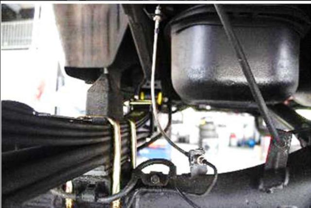
Tauschen Sie die vorhandenen Bremsschläuche zwischen Rahmen und Achse mit den mitgelieferten verlängerten Stahlflexbremsschläuchen.
