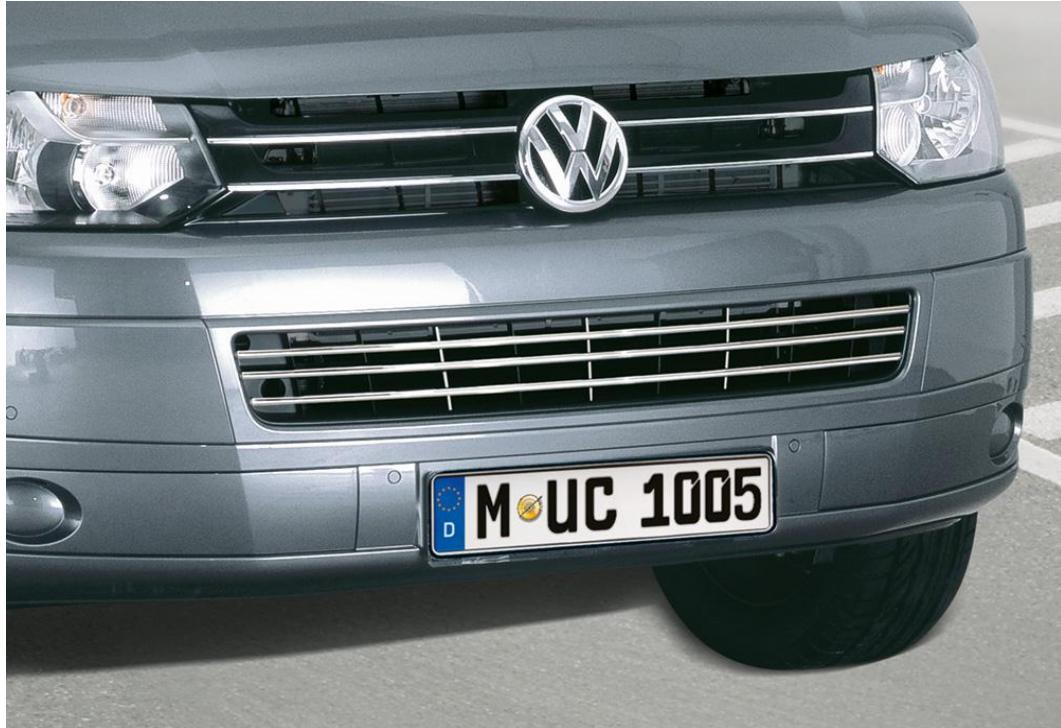
Lüftungsgitter aus spiegelpoliertem Edelstahl. Schützt den Kühler vor Beschädigungen. Unsere Lüftungsgitter werden mit TÜV Gutachten geliefert. Die Montagezeit beträgt ca. 10-30 Minuten. Für den VW T5 Modell ab 03/09
