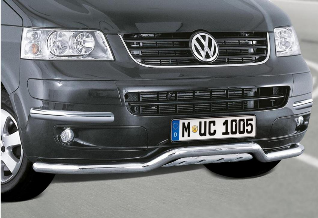
Spoilerschutzrohr aus spiegelpoliertem Edelstahl. Durch eine aufwendige Handpolitur unserer Edelstahlteile inkl. der Schweißnähte wird ein optimaler Korrosionsschutz gewährleistet. Unsere Spoilerschutzrohre sind TÜV geprüft und werden mit TÜV Gutachten geliefert. Die computergesteuerte Produktentwicklung gewährleistet eine optimale Passform und ein harmonisches Design. Die Montagezeit beträgt ca. 30-60 Minuten. Für den VW T5 Modell ab 03/09
