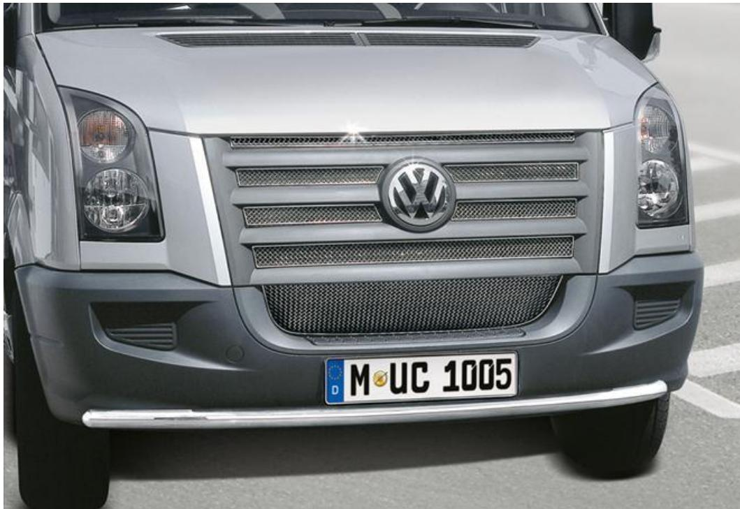
Spoilerschutzrohr aus spiegelpoliertem Edelstahl. Durch eine aufwendige Handpolitur unserer Edelstahlteile inkl. der Schweißnähte wird ein optimaler Korrosionsschutz gewährleistet. Unsere Spoilerschutzrohre sind TÜV geprüft und werden mit TÜV Gutachten geliefert. Die computergesteuerte Produktentwicklung gewährleistet eine optimale Passform und ein harmonisches Design. Die Montagezeit beträgt ca. 30-60 Minuten. Für den VW Crafter Modell 2006 & 2011
