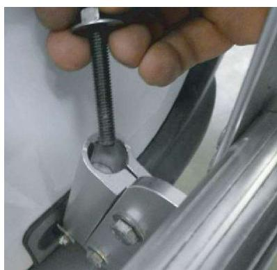
D. Entfernen der Schraube vom unteren Türbügel (4) durch Lösen der Mutter.
