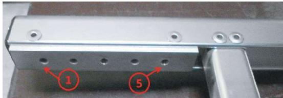
A. Installieren Sie den rechten unteren Türbügel in die richtigen Löcher, je nach Fahrzeugtyp.
