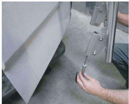
A. Installieren Sie eine der 2 unteren Türhalter (2) mit der "unteren Haltestange" (3) in die "unteren roten Klammern" (4) und hängen Sie die Halterung an der Unterkante der Tür.
