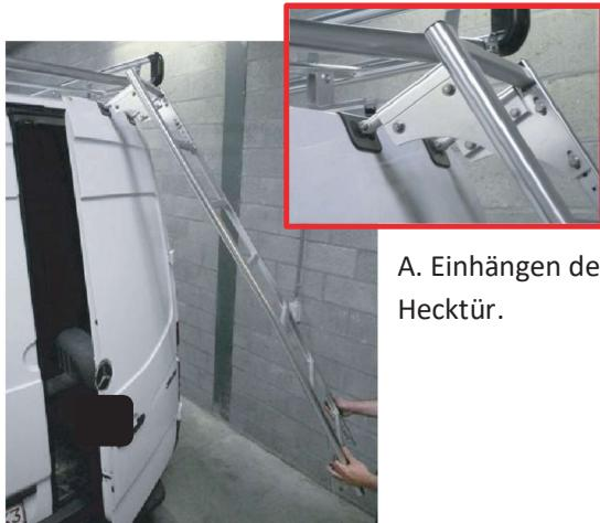
A. Einhängen der Leiter mit den 2 oberen Türbügeln (1) an die Hecktür.
