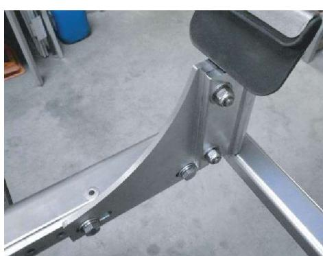
Verwenden Sie 2 x M8 x 20mm mit Unterlegscheibe und Federring.
