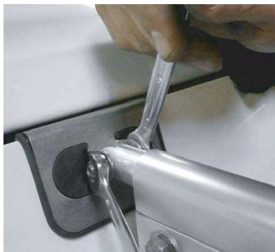
B. Anziehen der Schraube und Mutter aus dem linken und rechten oberen Türhalter" (1) mit 8 Nm.
