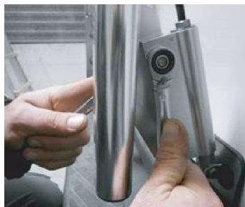
B. Anziehen der oberen Schraube der "unteren Aufhängestange" (4) bis 12 Nm.
