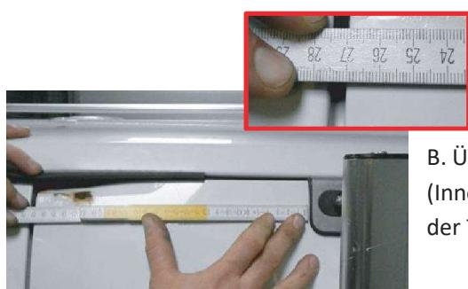
B. Überprüfen Sie, ob der Abstand zwischen der Türkante (Innenseite) und dem oberen Türbügel (1) dem Wert E in der Tabelle entspricht.
