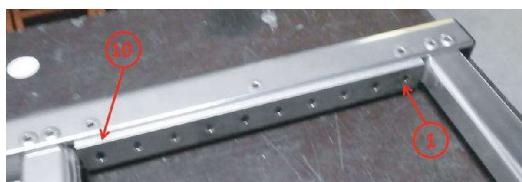
A. Installieren Sie den oberen rechten Tür Bügel in die richtigen Löcher, je nach Fahrzeugtyp.
