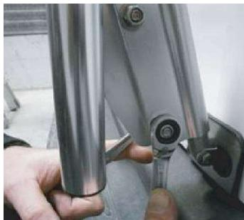
C. Anziehen der unteren Schraube der "unteren Aufhängestange" (4) bis 12 Nm.
