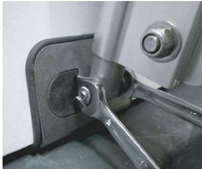
A. Anziehen der Schraube und Mutter aus dem linken und rechten unteren Türhalter" (2) mit 8 Nm.
